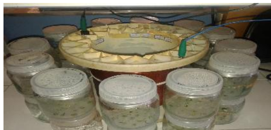
شکل ۱- دستگاه تولیدکننده میدان مغناطیسی و چیدمان کشت‌ها برای قرار گرفتن در معرض میدان (شیشه‌های زیرین نقش نگهدارنده دارند و جزو آزمایش نمی‌باشند)
