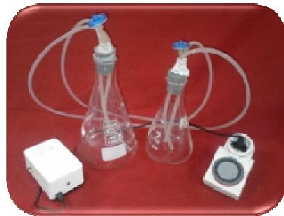
شکل ۲- بیوراکتور یک لیتری شبیه‌سازی شده با ارلن.
