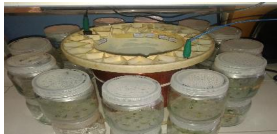
شکل ۱- دستگاه تولیدکننده میدان مغناطیسی و چیدمان کشت‌ها برای قرار گرفتن در معرض میدان (شیشه‌های زیرین نقش نگهدارنده دارند و جزو آزمایش نمی‌باشند)
